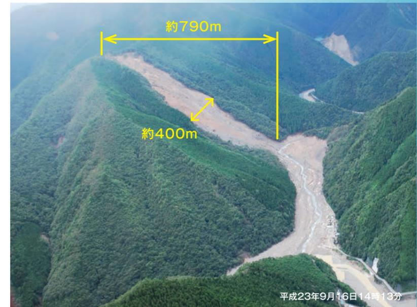
**4** 川原樋川沿いの赤谷・清水地区では、明治十津川大水害時の崩壊地側部が拡大崩壊しました。
