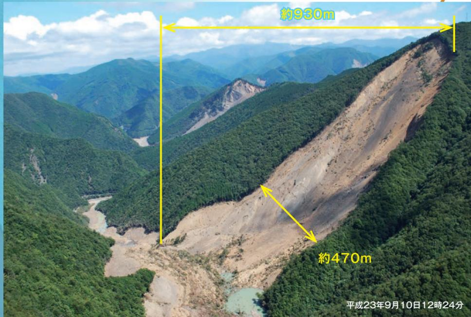
**2** 赤谷地区で発生した深層崩壊により、下流約1km地点の赤谷キャンプ場が被害を受けました。崩壊土砂は赤谷を閉塞し、湛水池が形成されました。
