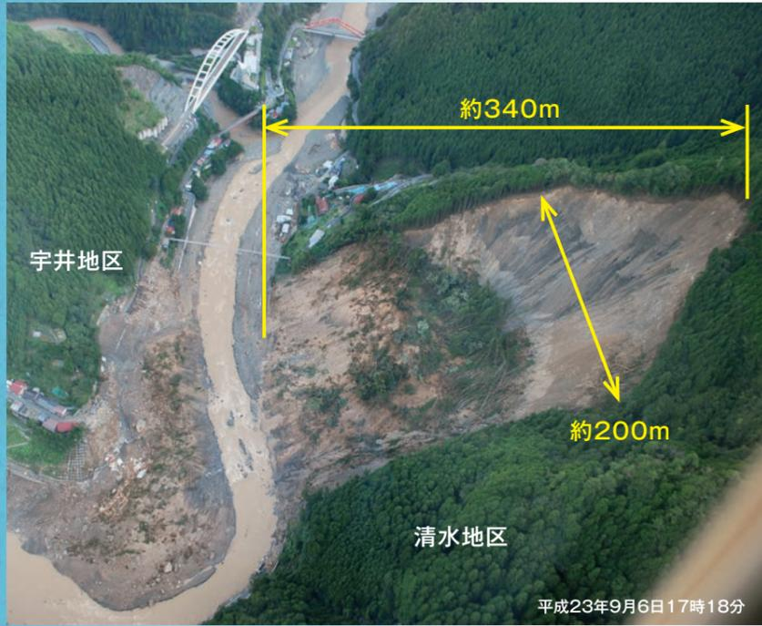
**1** 清水地区で発生した深層崩壊により、対岸の宇井地区で大きな被害が発生しました。崩壊土砂は一時、熊野川(十津川)を閉塞し、決壊しました。
