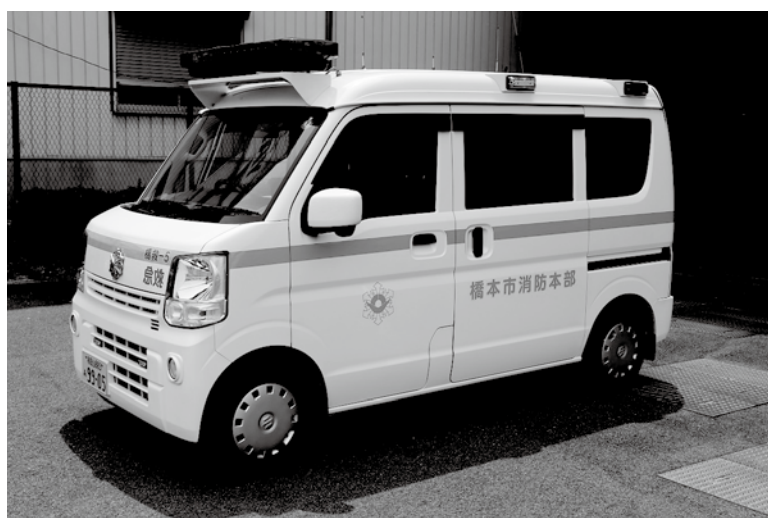
軽自動車タイプ救急車 (写真 橋本市提供)
